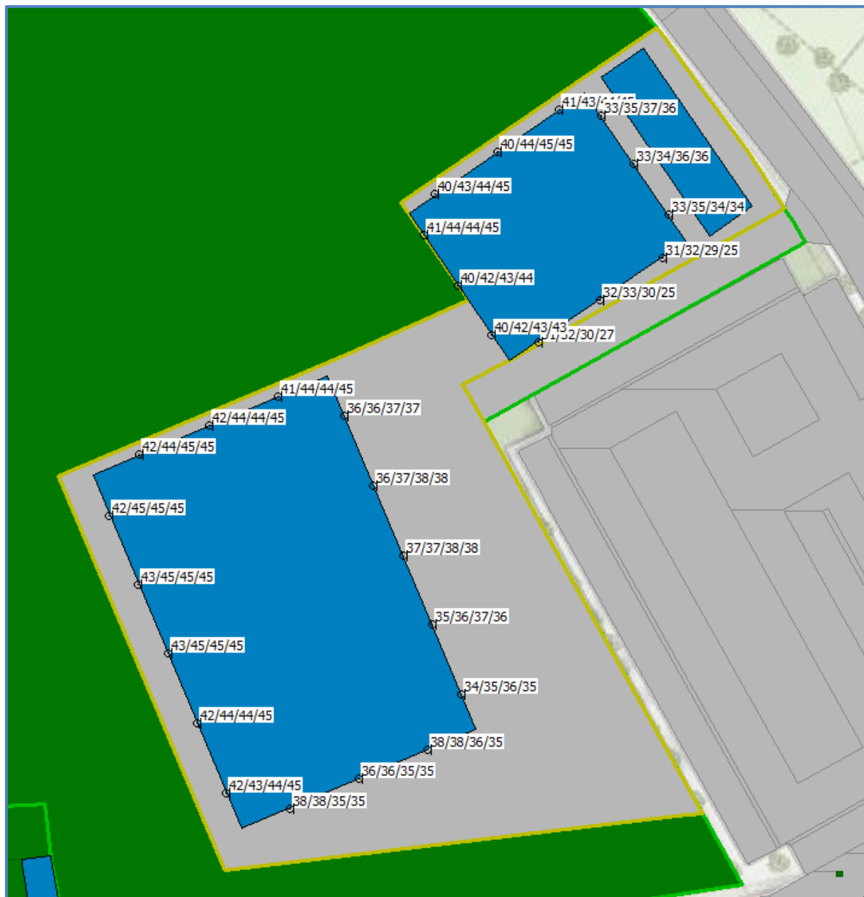
Afbeelding 8. Geluid L_{den} (incl. aftrek art. 110g Wgh) Provinciale weg N271 Berekend geluid op een hoogte van 3,0 ; 6,0 ; 9,0 en 12,0 meter
