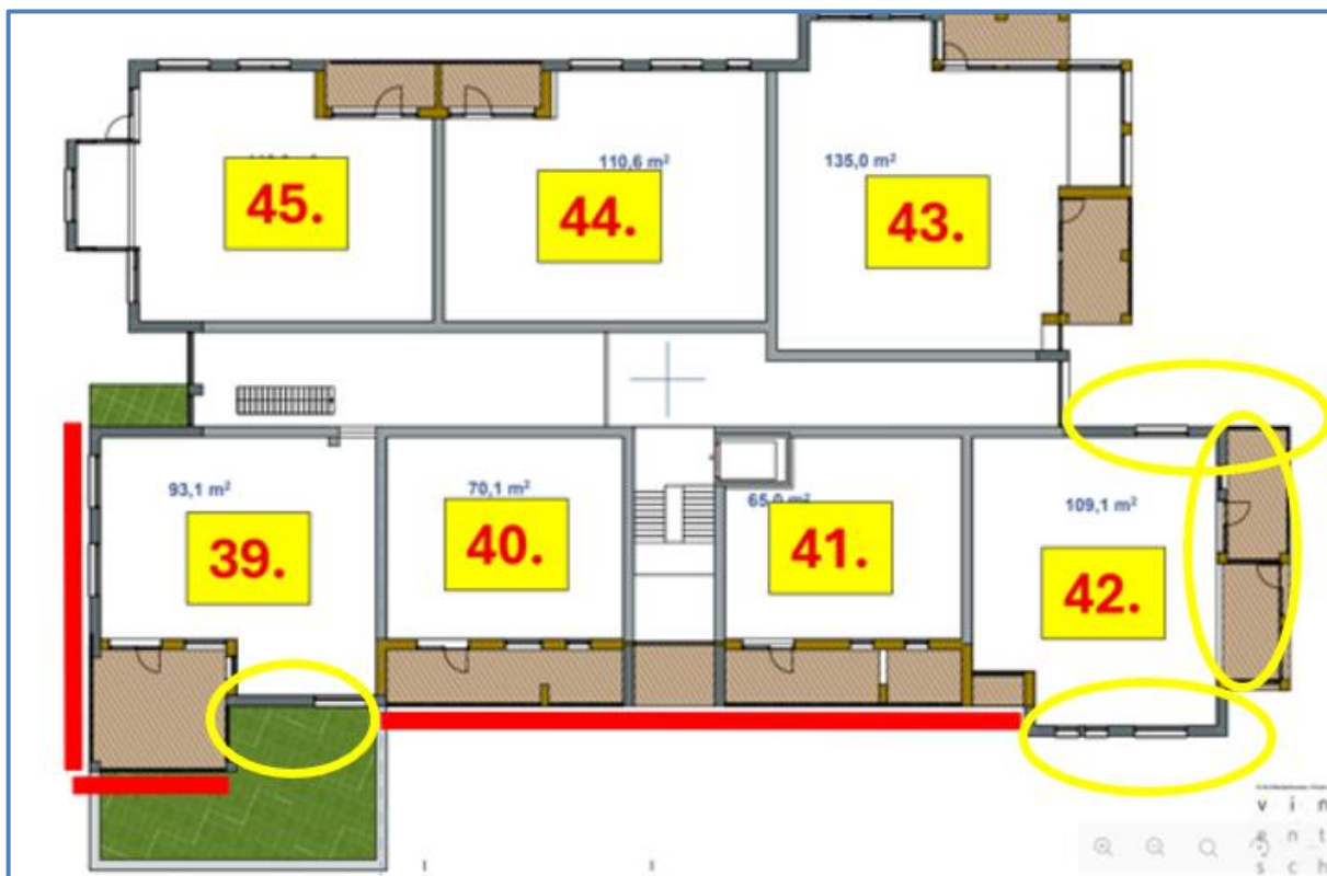
Afbeelding 13. Geluidluwe gevels bij appartementen bouwmassa 2 (2 e etage)
